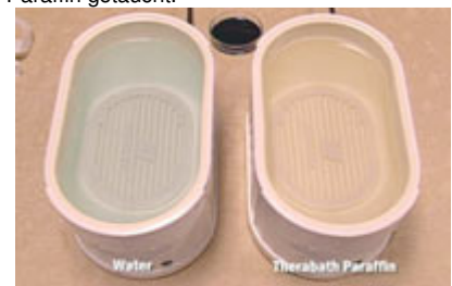
Diese Demonstration weist nach, dass sich wasserlösliche Verunreinigungen nicht in das Paraffinbad eintragen lassen.
